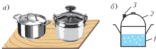
Рис.2. а) Обычная кастрюля и кастрюля-скороварка; б) устройство кастрюли-скороварки: 1 – корпус, 2 – крышка с затягивающим винтом, 3 – клапан-предохранитель
