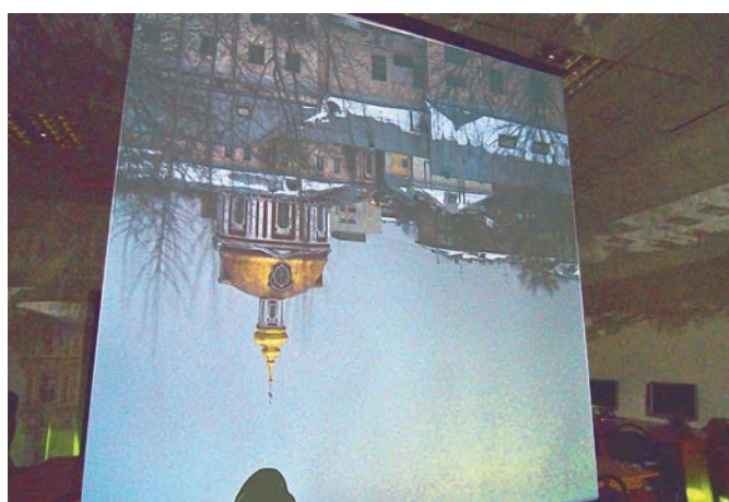
Рис. 3. Изображение на экране, приближенном к отверстию в окне; внизу видна тень от камеры, установленной на штативе
